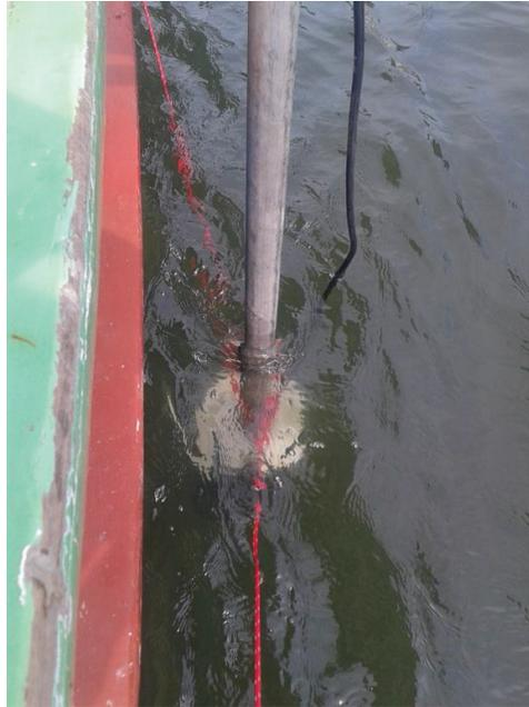
**Figura 240** – Ecobatímetro de dupla frequência Hidrobox Syqwest instalado na embarcação.
