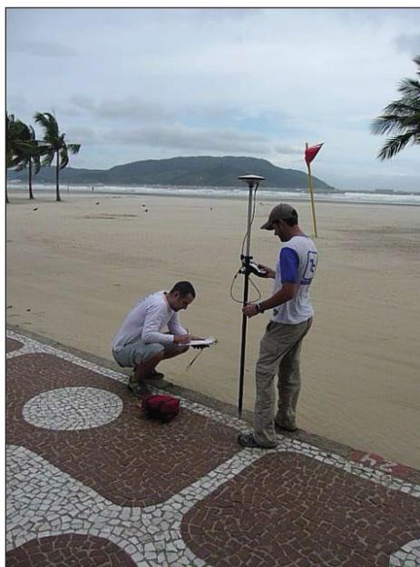
**Figura 197** – Georreferenciamento de marco de referência na base do perfil de praia e equipamento utilizado, em detalhe.
