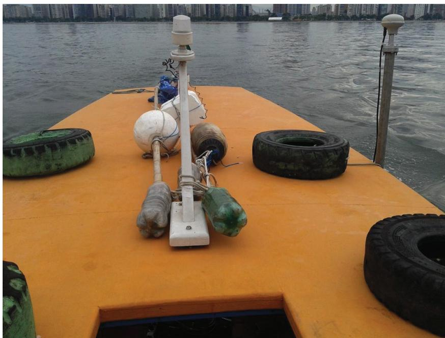
*Figura 241 – DGPS Novatel Smart V1 montado na embarcação.*
