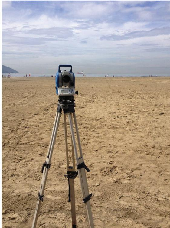
**Figura 199** – Estação Total Focus 6 utilizada nas medições de perfil praia.
