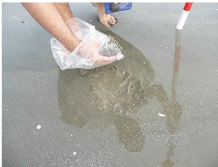
**Figura 174** – Exemplo da amostra de sedimento coletada para análise granulométrica.
