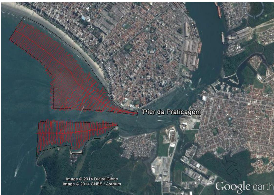
**Figura 203** – Mapa com as linhas batimétricas levantadas na Baía de Santos. Em destaque a localização do Pier da Praticagem onde foi realizada a leitura de maré.
