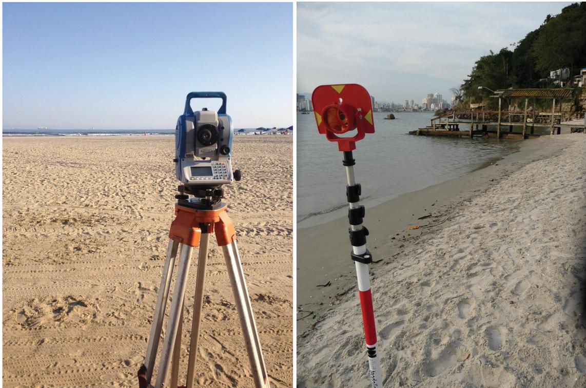
**Figura 172** – Estação Total Focus 6 utilizada nas medições de perfil praial (esquerda) com destaque ao prisma de medição (direita).
