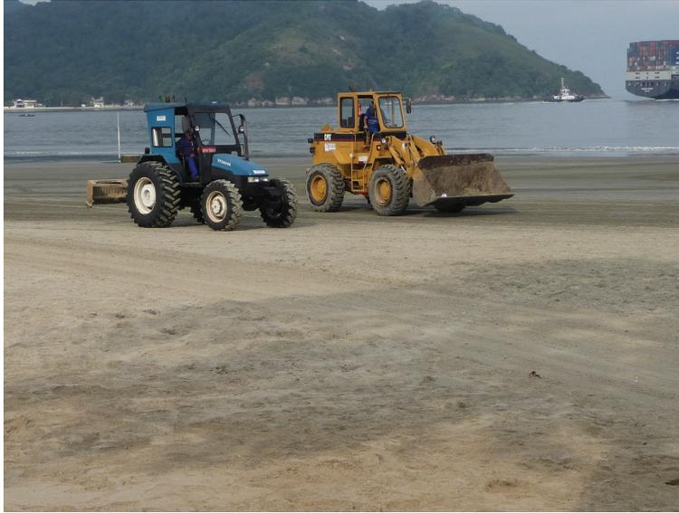
*Figura 185 – Trator e escavadeira remobilizando areia depositada entre os perfis S-20 e S-23.*
