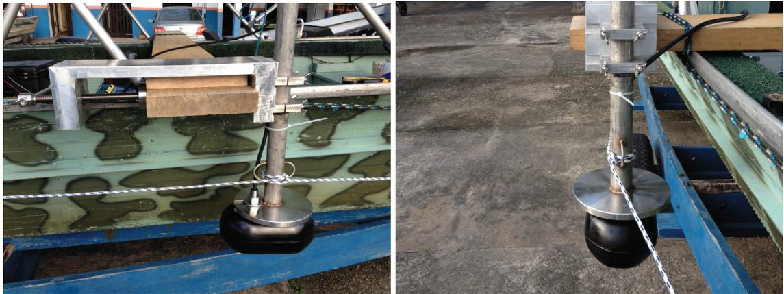
**Figura 201 – Ecobatímetro de dupla frequência Hydrobox Syqwest instalado na embarcação.**
