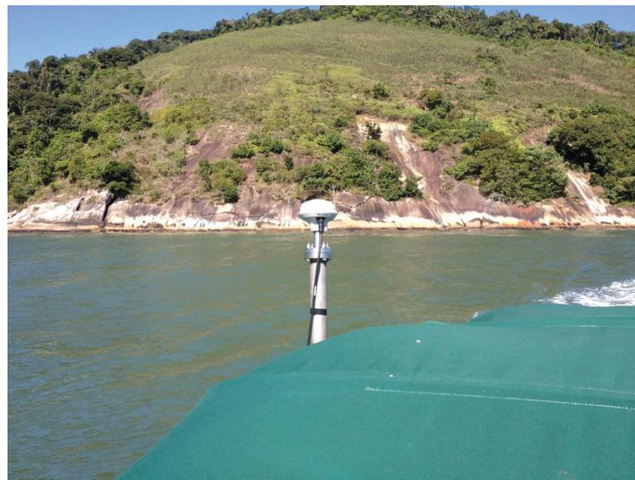
**Figura 202 – DGPS Novatel Smart V1 montado na embarcação.**
