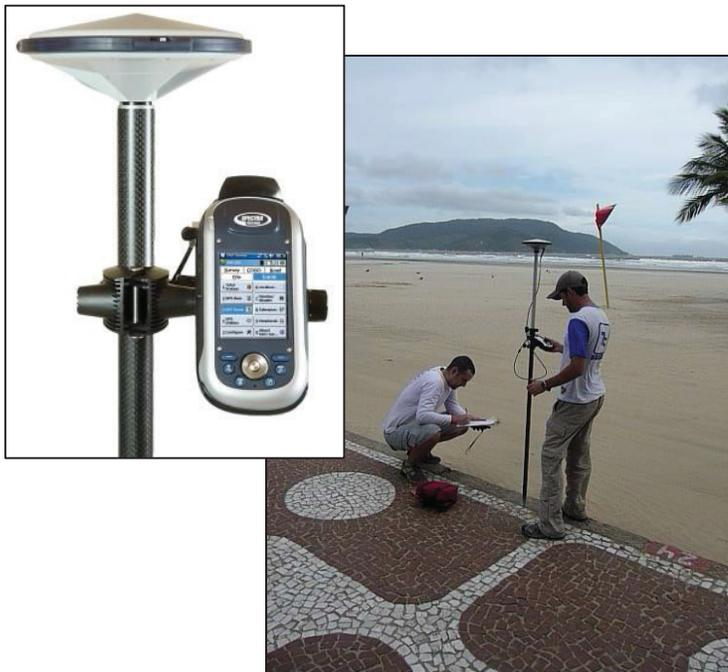
**Figura 170** – Georreferenciamento de marco de referência na base do perfil de praia e equipamento utilizado, em detalhe.
