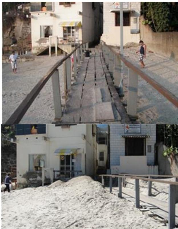
Figura 8.3.1.1.1-3. Perfil Góes-05 (setor E da praia), durante fase de maior evolução do fenômeno de rotação praial, em junho de 2010 (acima), e após uma forte ressaca, em agosto de 2010 (abaixo). Nota-se forte empilhamento de sedimentos devido à ressaca de agosto, parte dos quais remobilizados antropicamente para a desobstrução da passarela de acesso à via.
