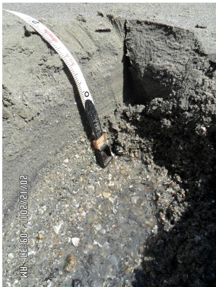
Figura 8.3.2.3-3. Empilhamento de areias no baixo estirâncio do perfil Góes-01, em dezembro de 2011, exibindo afinamento gradativo e bem marcado da base para o topo (areias muito grossas com cascalho biodetrítico na base, que passam a areias grossas, médias, finas e muito finas no topo).
