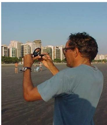
Figura 8.2.1-3. Posicionamento do perfil praiar (perpendicular à linha de costa) utilizando a visada da bússola geológica do tipo Brunton e tendo como mira o ponto inicial fixo do perfil.
