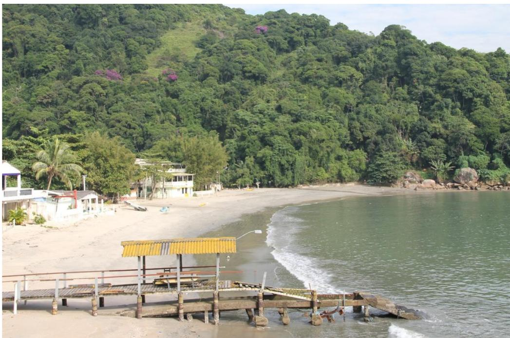
Figura 8.3.2.5-2. Forte erosão do píer de atracação no final da ressaca de 03-04 de maio 2011, e incidência oblíqua de ondas na linha de costa, indicando transporte para E (imagem de 04 de maio de 2011, Praia do Góes).
