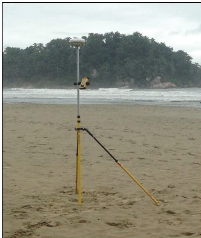
Figura 2-3. Receptor móvel Trimble R4 pronto para levantamento.
